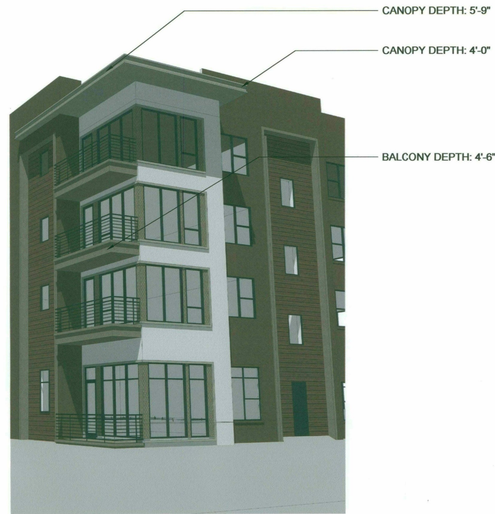
5 SECONDARY CORNER BALCONY SHADING SCALE: N.T.S.
