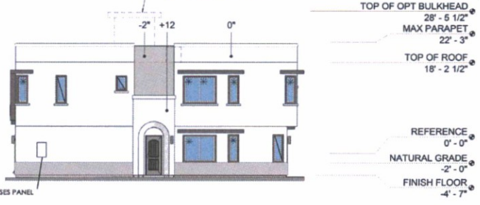
4 6 PLEX - RIGHT SIDE ELEVATION SCALE: 1/8" = 1'-0"
