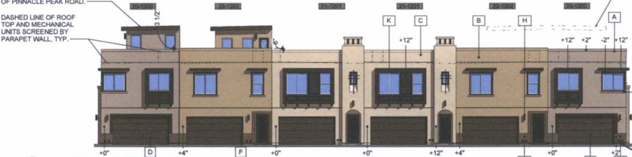
1 6 PLEX - FRONT ELEVATION A3.110 SCALE: 1/8" = 1'-0"
