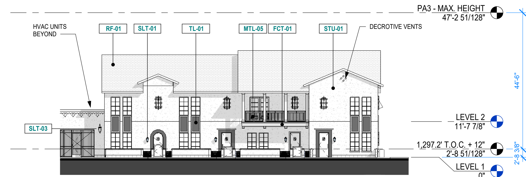
6 PA3 - D1 - NORTH ELEVATION - BW 1/16" = 1'-0"
