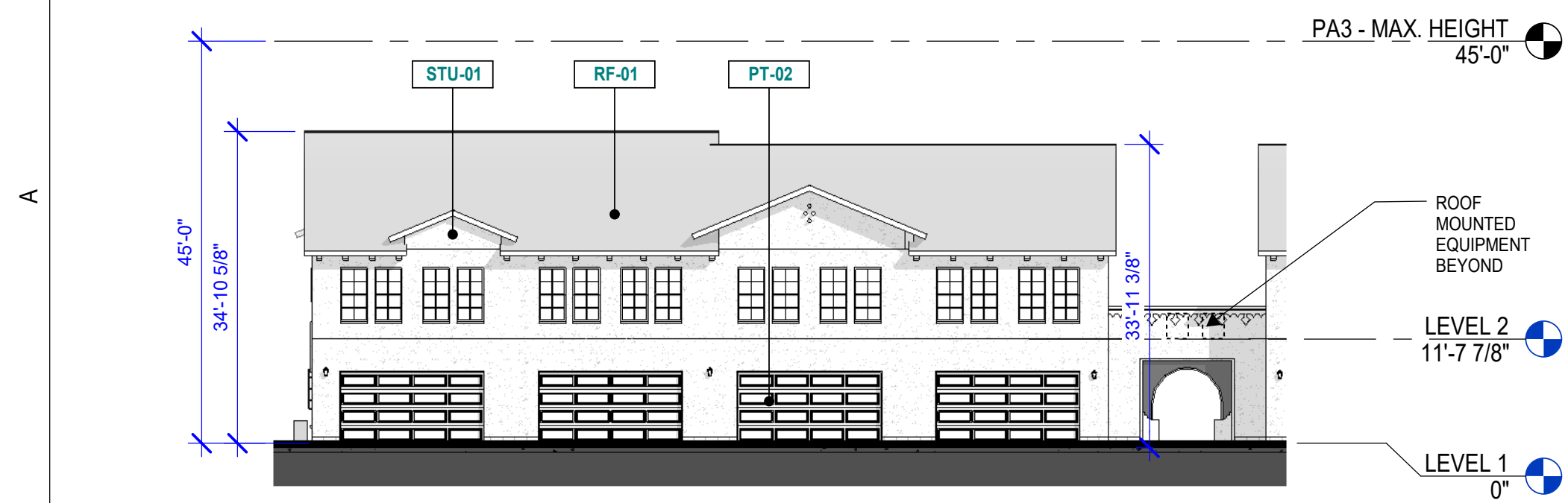
5 PA3 - D1 - SOUTH ELEVATION - BW 1/16" = 1'-0"
